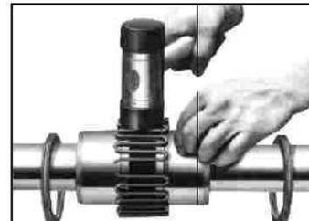
Encha a folga e as ranhuras com graxa especificada antes de inserir a grade. No caso de grades fornecidas em dois ou mais segmentos, instale-as de modo que as pontas cortadas se estendam na mesma direção; isto irá assegurar que o contato da grade com os pinos não rotativos das tampas ocorra corretamente. Estenda ligeiramente a grade de modo que passe sobre as ranhuras do cubo e assente-a com um martelo de fibra ou borracha.
